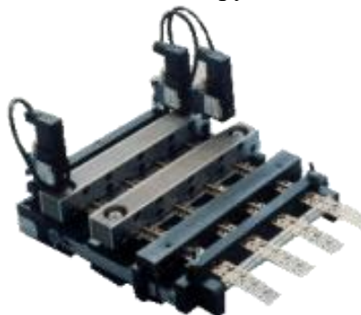
Мультиподающее устройство для предварительно отштампованных полос.
